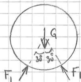
Kontaktkraft  $F_I$  virker normalt på overflaten
